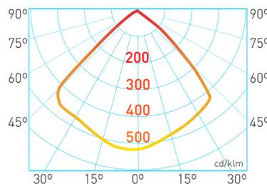
Ao mesmo tempo, os ELLINGTON têm ângulos de feixe de 60° ou 90°, potências de 50W, 100W, 150W, 200W ou 300W e podem ser suspensos com o kit adequado, características técnicas que permitem converter este tipo de projetor numa campânula adequada para iluminar áreas industriais, linhas de montagem, armazéns, etc. Poucas luminárias no mercado permitem esta versatilidade aliada a uma potência elevada e a uma eficiência luminosa considerável.
